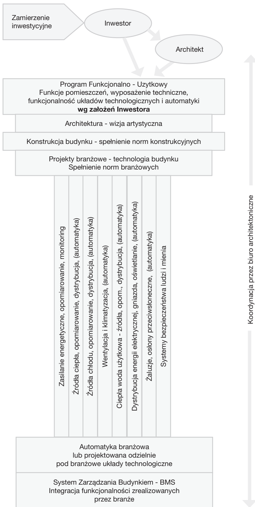
Rys. 1. Schemat klasycznego procesu projektowania budynku z uwzględnieniem wymagań inwestora
